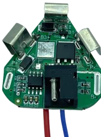
3.5-сурет – BMS контроллері (Li-Ion тақтасы)
